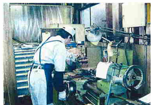
微妙な研削、切削などはベテラン職人が機械を手で操作して仕上げる
