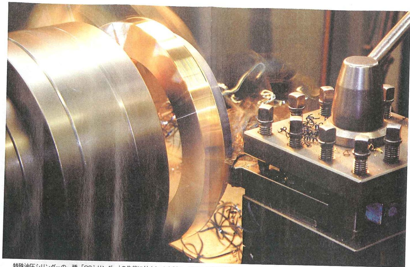
特殊油圧シリンダーの一種、「QSシリンダー」の先端に付くナットを削る。微妙な切削作業はベテラン職人の手にゆだねられる。
