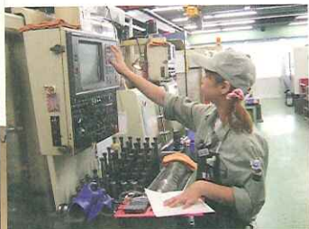
製造数の多いものは、マシニング加工により部品の削り出しを行う
